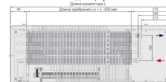
● → - обратный трубопровод ● ← - подающий трубопровод
