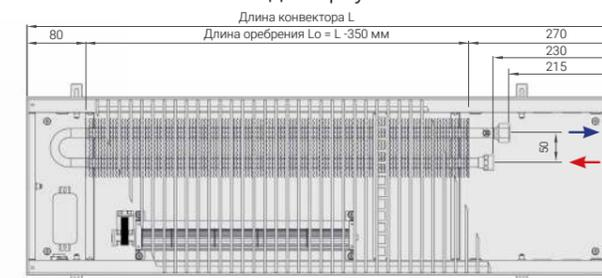
● → - обратный трубопровод ● ← - подающий трубопровод
