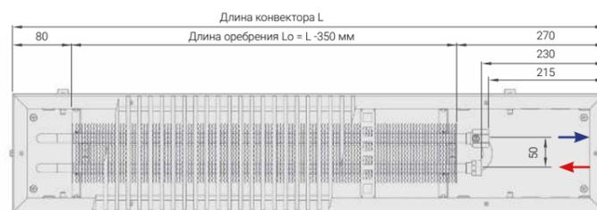
● → - обратный трубопровод ● ← - подающий трубопровод
