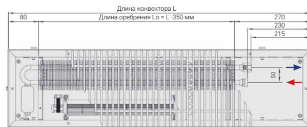
● → - обратный трубопровод ● ← - подающий трубопровод
