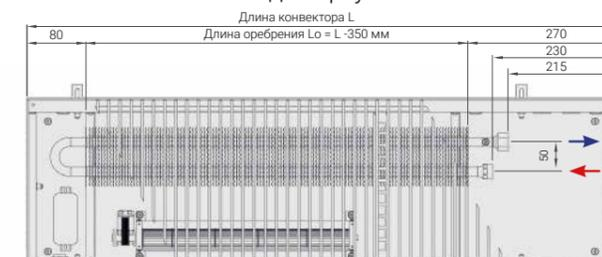
● → - обратный трубопровод ● ← - подающий трубопровод
