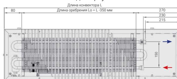
● → - обратный трубопровод ● ← - подающий трубопровод
