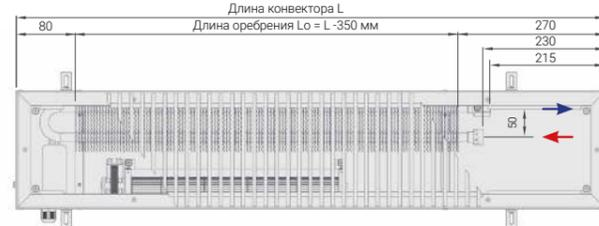
● → - обратный трубопровод ● ← - подающий трубопровод
