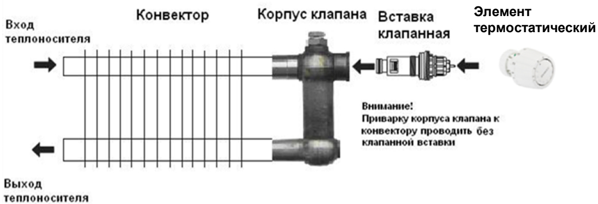
Рис. 4 – Схема монтажа терморегулятора системы отопления.
